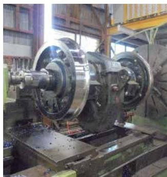
協力会社による車輪削正を実施しております。写真は花輪出張所向けHTR600R(S1403R号車)の車輪削正の様子です。
