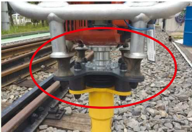
ゴム緩衝材により振動を低減
