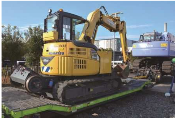
8t軌陸クレーンで牽引
