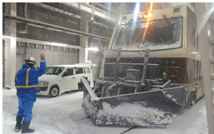
《写真は確認車車庫収納時の着雪状況》
